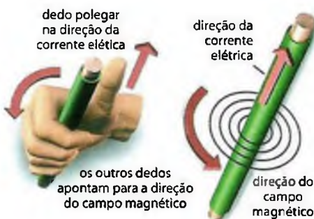
Orientação de um campo magnético produzido por uma corrente elétrica.
