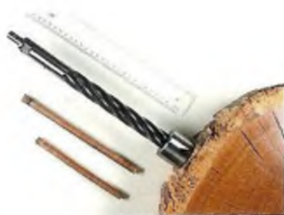
Broca utilizada pela dendrocronologia para extrair um pequeno cilindro de um tronco contendo os "anéis" formados pelo crescimento da árvore.
