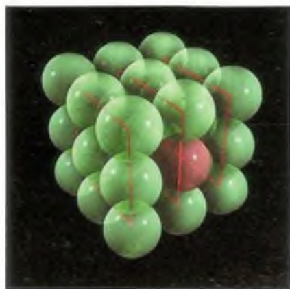
Estrutura atômica cúbica simples com uma impureza em um local do retículo cristalino (vermelho)
